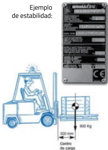
Fig. 1. Con el mástil levantado e inclinado hacia atrás: b_1 > b : Hay mayor estabilidad estática
